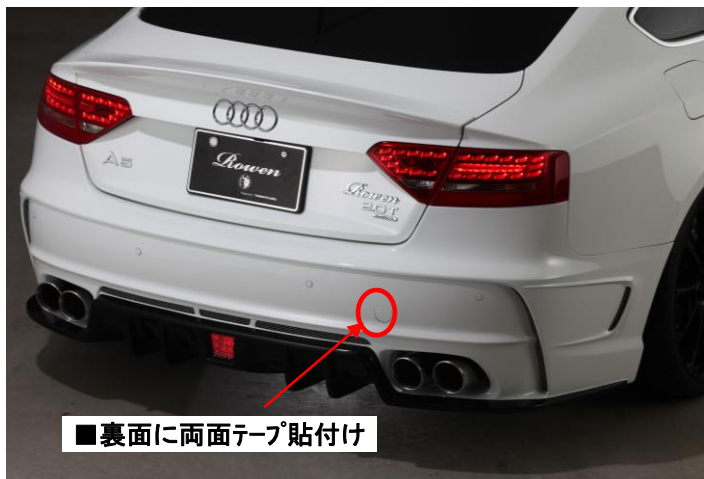
■純正リヤバンパーサポート移設して下さい。 ※PTCセンサーとバンパーサポートが干渉しますので、干渉部付近をカットする必要がありますが御座います。 ※バンパーサポートの点線部(ロック部)周辺をカットする必要がありますが御座います。
